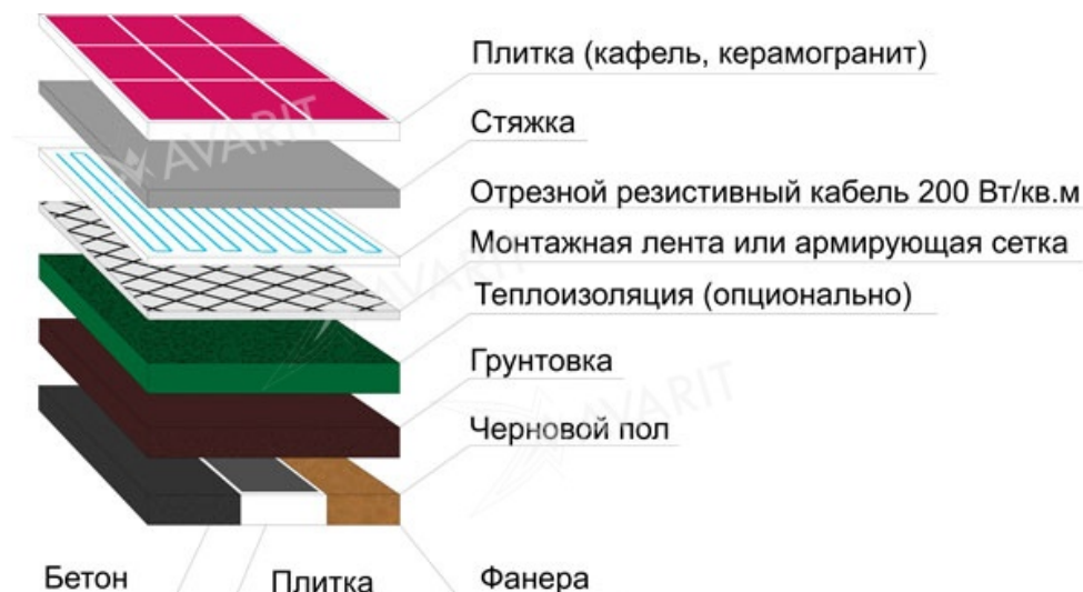
Рис. 2. Установка греющего кабеля под плитку (основное отопление или на веранде, в гараже, на балконе)
